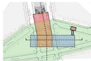
Riga 13: quais en galerie - boîte coté VBH - accès discret sur le square - émergence parallèle à l'axe du tunnel
