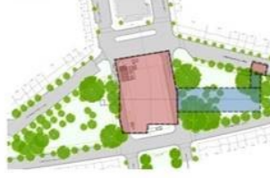
Riga 16: quais en galerie - boîte coté tilleul - accès discret sur le square - émergence perpendiculaire à l'axe du tunnel
