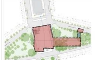
Riga 14: cut&cover - boîte coté Tilleul - accès discret sur le square - émergence perpendiculaire à l'axe du tunnel
