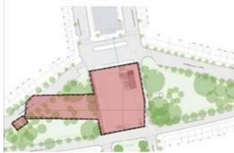
Riga 14: cut&cover - boîte coté Tilleul - accès discret sur le square - émergence perpendiculaire à l'axe du tunnel
