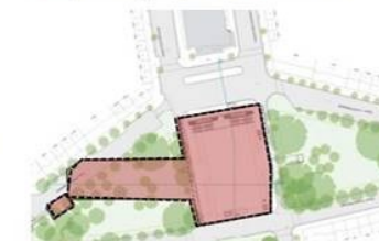
Riga 15: cut&cover - boîte coté Tilleul - accès discret sur le square - émergence parallèle à l'axe du tunnel
