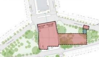
Riga 15: cut&cover - boîte coté Tilleul - accès discret sur le square - émergence parallèle à l'axe du tunnel
