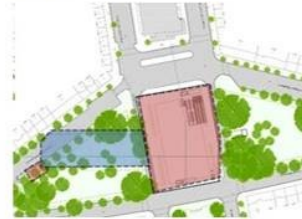
Riga 16: quais en galerie - boîte coté tilleul - accès discret sur le square - émergence perpendiculaire à l'axe du tunnel
