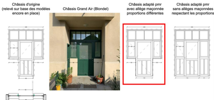
Ici, adaptation pour les porches sous balcon, le même principe est proposé pour les porches secondaires (une seule allège) (extr. de la demande de permis)
