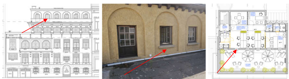
Elevation, vue et plan de la fenêtre à transformer en porte-fenêtre (extr. du dossier de demande)
