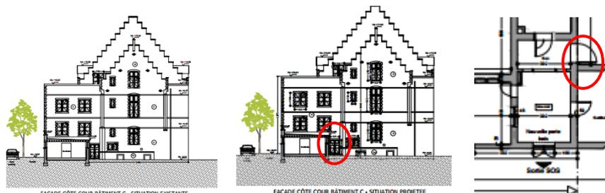
A gauche : porte existante à double battant. Au centre : porte à double battant (élévation projet 005C).
