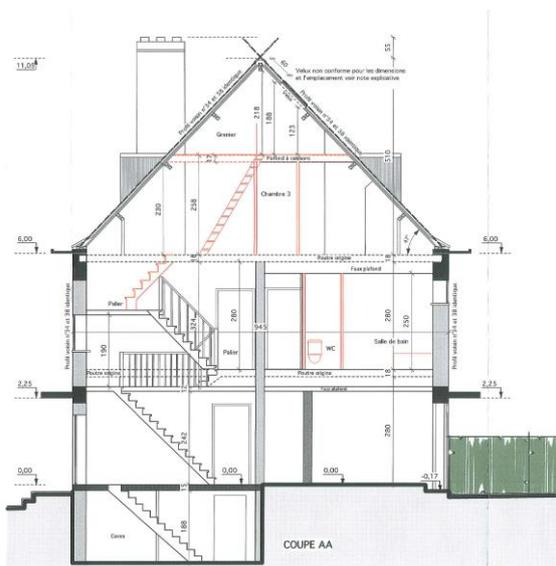
**1. Travaux à régulariser : Aménagement d'une suite parentale sous combles avec un grenier en mezzanine et placement de deux escaliers avec un palier.**
