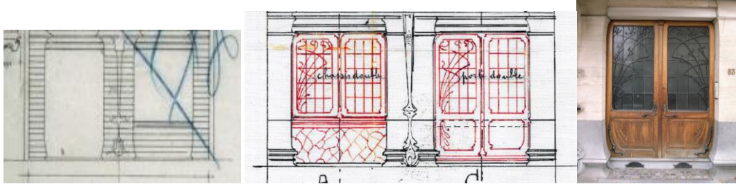
A gauche : détail du permis de bâtir de 1900. Au centre : détail permis de 1908 pour intervenir porte et fenêtre. A droite : la porte actuelle.
