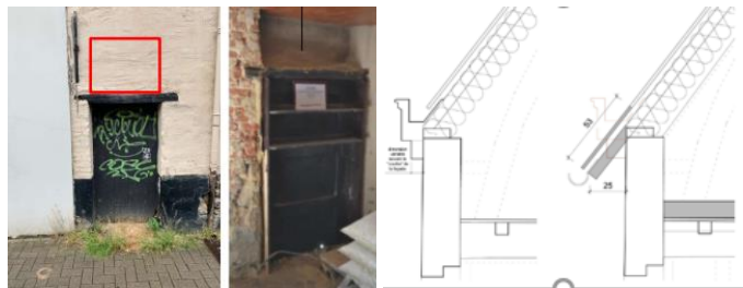
A gauche, linteau de porte d'entrée à surhausser. A droite, prolongation du pan de toiture avant (extraits du dossier)
