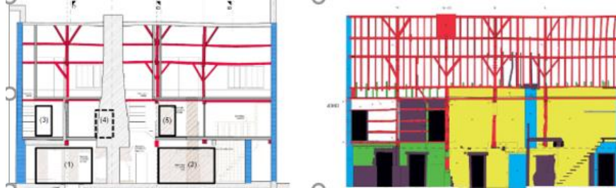
Mur gouttereau du bâtiment A – percements prévus (extraits du dossier)
