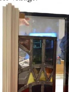
Echantillon de la structure en métal de la double peau de la loggia (vu de profil et de face), PV de réunion du 03/02/2022
