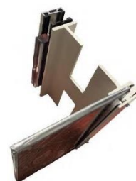
Échantillon de la structure en métal de la double peau de la verrière du lobby, PV de réunion du 03/02/2022
