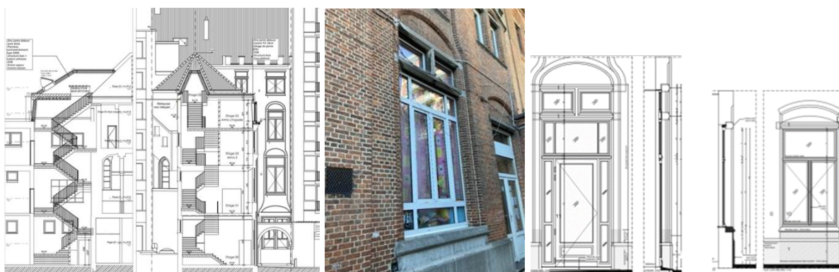
A g. : nouvelle cage d'escalier : coupes – Au milieu et à dr. : travée du RDC du «corps de logis » : nécessité d'inverser les fenêtre et porte pour ménager un accès au nouvel escalier : situation existante et élévation projetée (élévations et coupes)
