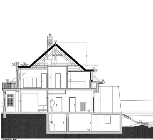
Coupe projetée avec l'isolation en sarking, plan de la parcelle avec l'abattage prévu et vue du bouleau situé à l'arrière (extr. du dossier de demande)
