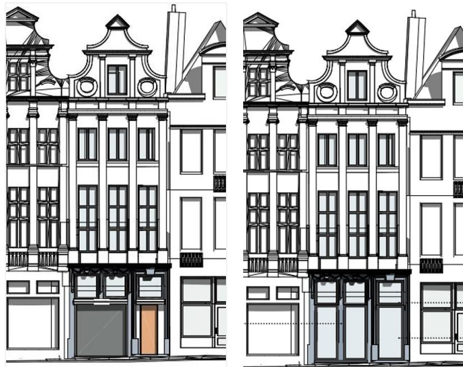
Schémas des états existants et projetés de la façade 3, rue de la Tête d'Or
