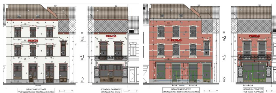
Situations existante et projetée (partiellement de fait) des façades (extraits du dossier)
