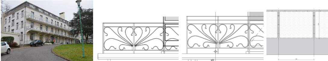
Façade ouest de l'aile hospitalière, garde-corps existants et variantes projetées (documents extraits à la demande)
