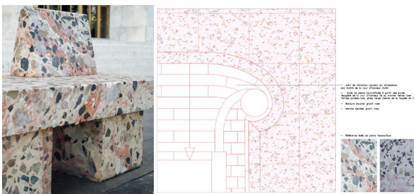
Pierre reconstituée et détail du calepinage à proximité de l'escalier monumental (plan extrait du dossier).
